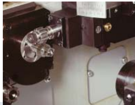
Zahnradfräsen auf der SR-20R (ohne Revolver)
