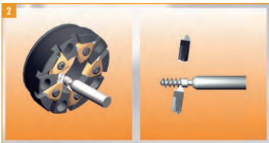
Das Gewindewirbeln beginnt. Das Gewinde wird mit einer rotierenden Bewegung der C-Achse und einer Längsbewegung der Z-Achse gefertigt, wobei immer nur eine Schneide der Schwanog-Wirbelspindel im Einsatz ist.
