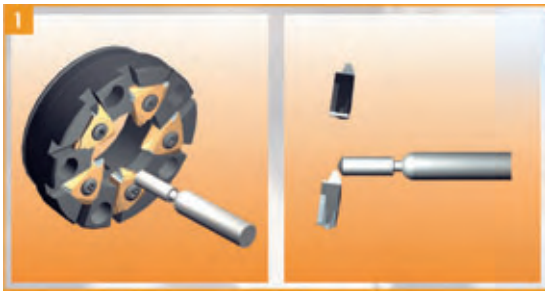
Das Schwanog-Wirbelwerkzeug wird vor das Werkstück eingerichtet und dreht sich mit hoher Drehzahl. Die Werkstückspindel dreht sich mit niedriger Drehzahl in gleicher Richtung (Gleichlauf).
